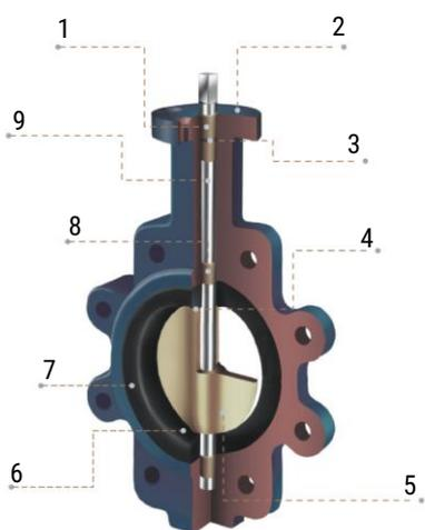
1. Верхнее уплотнение: предотвращает попадание пыли и грязи внутрь корпуса, а также протечки по валу.
